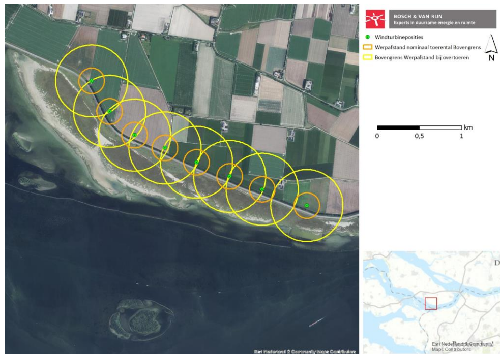
Figuur 14 – Werpafstand bij nominaal toerental en overtoeren en buisleidingen en hoogspanningsinfrastructuur Bovenvariant.
